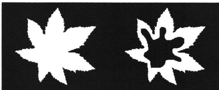
Figura 12: Método Dividers não leva em consideração a informação interna do objeto. A dimensão Fractal calculada é a mesma para os dois objetos.
