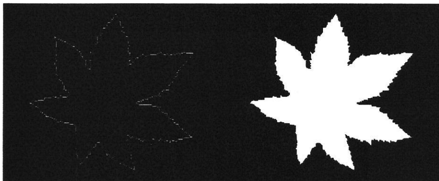
Figura 14: O Método de Massa-Raio necessita da informação interna do objeto para o cálculo. Apenas o contorno é insuficiente.
